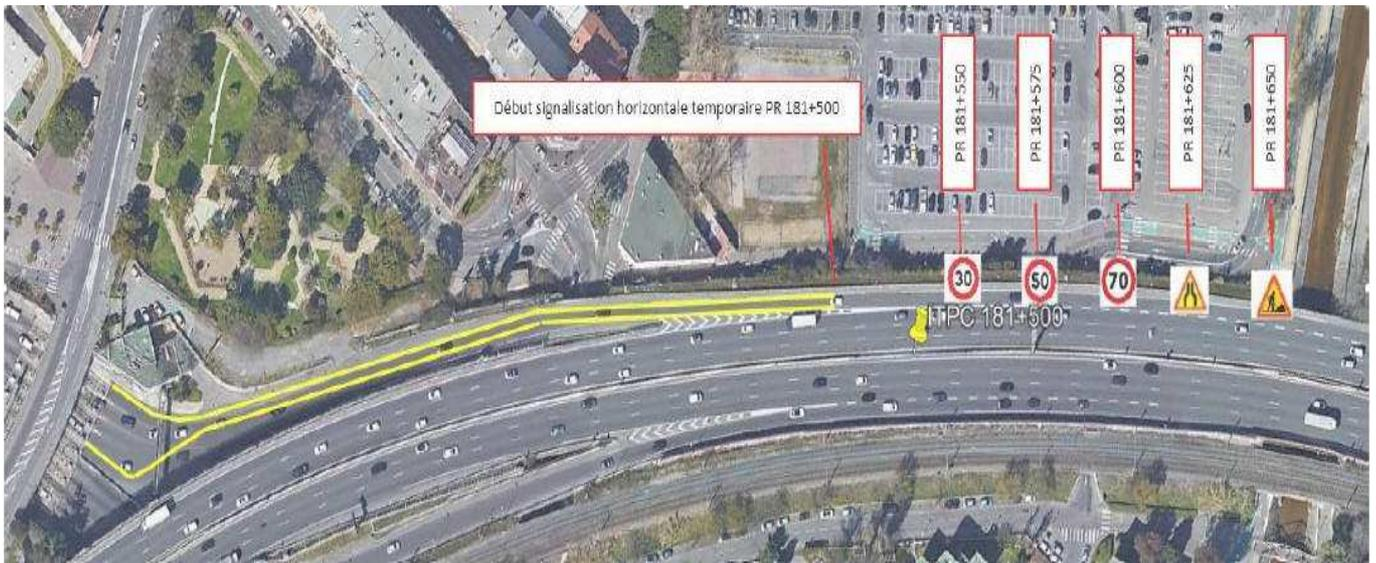
L'accès au chantier se fera par le biais de l'installation d'une passerelle en surplomb de la bretelle. La hauteur de la passerelle sera de 5.50 m. La hauteur libre minimum sur autoroute est de 4.50 m.
